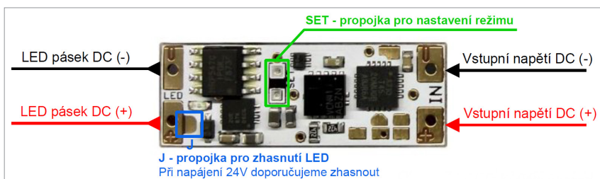
Obr. 1 - Zapojení vývodů modulu
